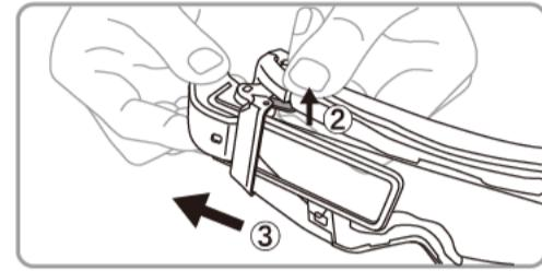
光学ユニット取付け部の着脱レバーを、矢印②の方向に押し上げながら、光学ユニット【VT-001】(別売)を矢印③の方向に引き抜いてください。
