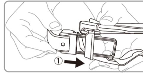
光学ユニット取付け部の開口部から、光学ユニット【VT-001】(別売)のホログラム導光板ディスプレイを矢印①の方向にカチッと音が鳴るまで、差し込んでください。
