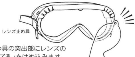
レンズ止め具の突出部にレンズの端の「レンズ孔」をはめ込みます
